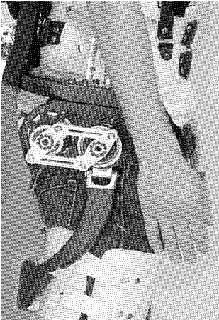
Cyberlegs: i sensori connessi da microchip regolano i movimenti
